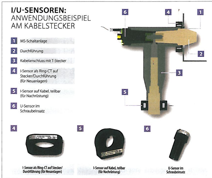
Bild 20: Anwendungsbeispiele Strom- und Spannungssensoren rund um den Kabel-T-Schraubstecker (Quelle: Dr. techn. J. Zelisko)
