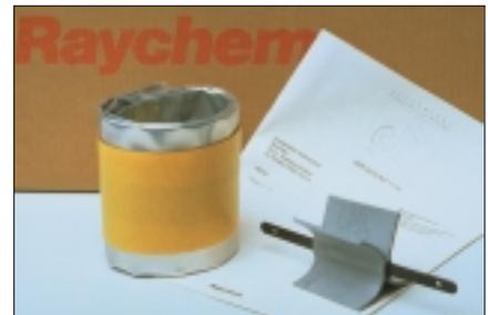
Bei Belegung mit drei oder mehr Kabeln sind Abdichtsterne (RDSS-Clip) in Kombination mit dem Abdichtelement RDSS zu verwenden. Ein RDSS-Clip kann bis zu vier Kabel abdichten. Werden mehr als vier Kabel eingeführt, ist für jeweils drei zusätzliche Kabel ein weiterer Abdichtstern zu verwenden.
