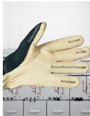
+ 5 Sicherheitsregeln für spannungsfreies Arbeiten.
