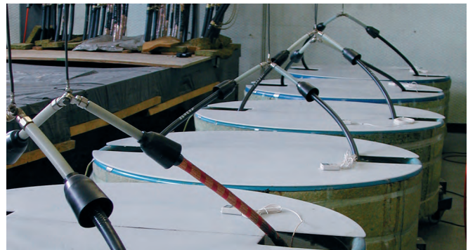
Bild 2: Langzeitprüfung nach HD 605 S2 und HD 620 S2
