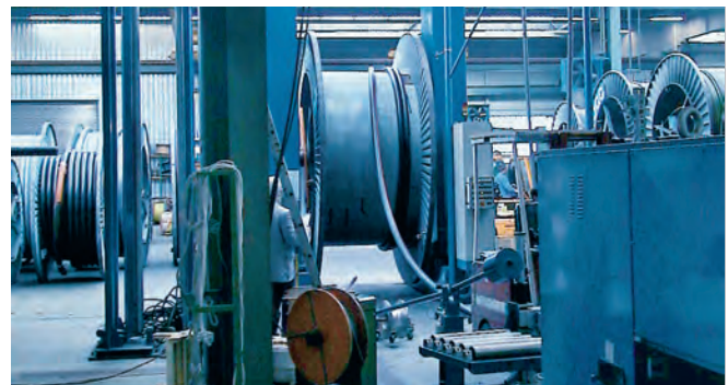
Bild 3: Biegeprüfung vor dem Start zur elektrischen Typprüfung.
