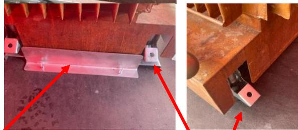
Der Zapf-Trafo wird mittig bis zur Anschlagleiste gefahren und mit Zurrgurten entsprechend befestigt. Die Räder des Zapf-Trafo sind in arretierte Stellung zu bringen (herunter drücken).
